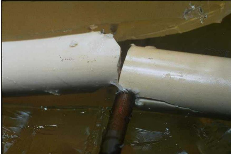
Abb. 3.-3. Kunstknochen: Schussbruch mit Radiärfraktur und Biegungskeil durch Feldspitze
