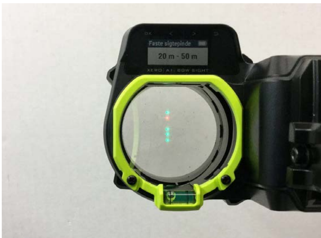
Elektronisk sigte med indbygget afstandsmåler
